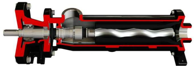
La Serie RJL è basata sulla stessa tecnologia della serie RL. Si differenzia per l'utilizzo di un supporto cuscinetti con albero in ingresso indipendente. La serie RJL è collegabile tramite giunto all'azionamento. La soluzione ideale per la fornitura di pompa ad asse nudo. I cuscinetti garantiscono la massima affidabilità in qualsiasi condizione operativa.
