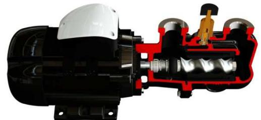
La Serie R è il prodotto più compatto disponibile grazie alla costruzione integrata tra pompa e motore elettrico e una parte idraulica estremamente corta. Utilizza uno snodo a doppio spinotto, affidabile di semplice manutenzione. Assente il supporto tra corpo pompa e azionamento a favore della compattezza e semplicità di manutenzione.
