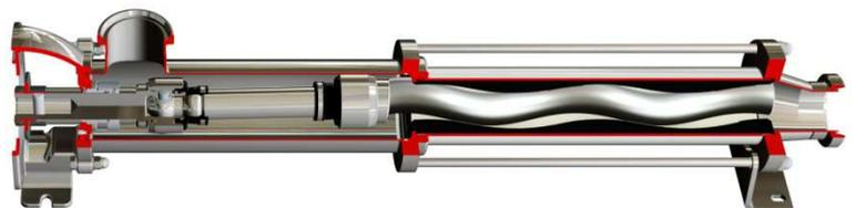
La serie DXC rappresenta la pompa sanitaria a snodo standard della serie DN. E' la soluzione che abbina ottime caratteristiche di sanificabilità grazie al design di casing completamente privi di zone morte e ristagni, insieme alle performance dello snodo a spinotto brevettato della serie Diamond. La lubrificazione dello snodo è indipendente dal prodotto pompato, pertanto è adatto anche a fluidi non abrasivi.
