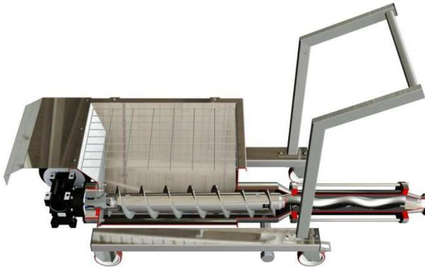
Versione dotata di tramoggia larga eccentrica, con carrello integrato. Ideale per il settore dell'enologia in abbinamento alle pigia diraspatrici. Per il pompaggio di uva pigiata con o senza raspo. Costruzione estremamente compatta e realizzata di serie in acciaio inossidabile AISI 304, in tutte le sue componenti.
