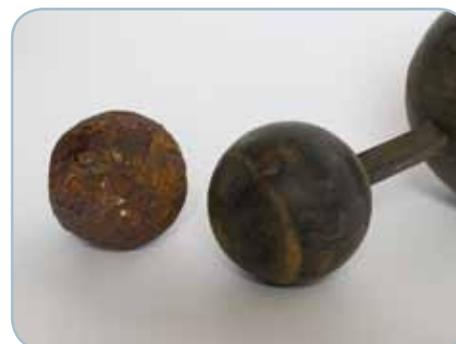
Un anno dopo l'installazione, ecco come si presentano una sfera metallica normalmente utilizzata nelle valvole di flussaggio della concorrenza (a sinistra) e la sfera in gomma impiegata nella FLX Zenit
