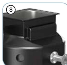
Predisposizione per 3 tubazioni di ingresso reflui Ø 160 mm con fissaggio rapido tramite guarnizioni in NBR senza l'impiego di prodotti sigillanti. Oltre alle predisposizioni standard fornite da Zenit, il cliente può realizzare a sua discrezione, e responsabilità, ulteriori ingressi, assicurandone l'isolamento tramite guarnizioni.
